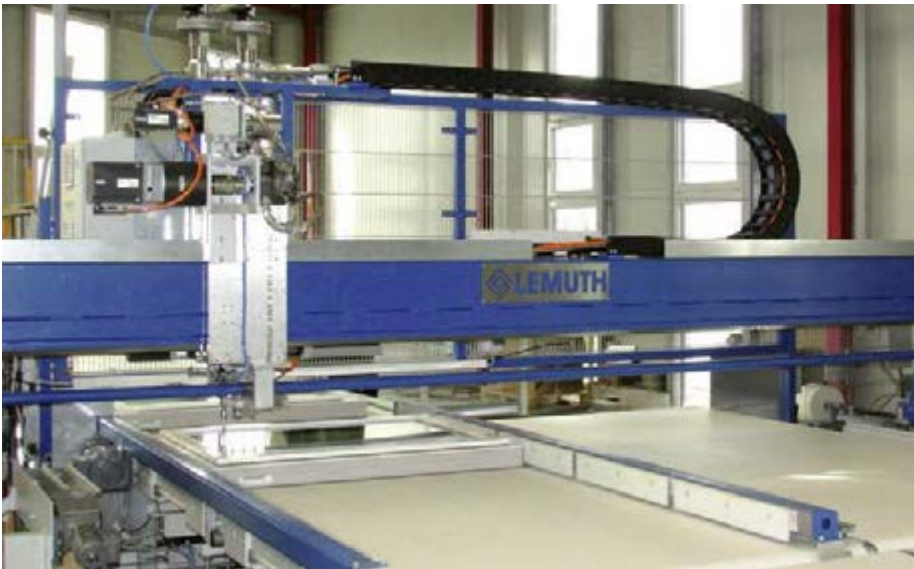
50 Prozent der Kunststoff-Fenster werden mit verklebten Scheiben ausgeliefert. Im Bild der neue Automat zur Scheibenverklebung.
