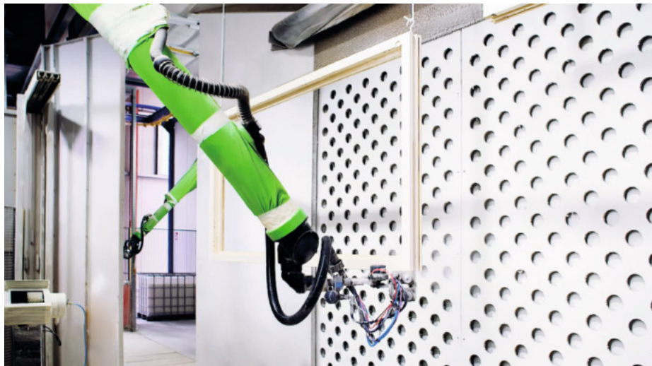
Bereits seit 2019 sind in der Beschichtung zwei Spritzroboter im Einsatz.
